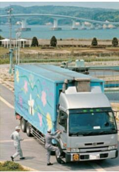
このマシンは、七尾市、中能登町の下水道から排出される汚泥を肥料化するもので、汚泥を脱水したものを、三〇〇〜四〇〇℃の熱で乾燥させる。乾燥にはジェットエンジンの技術も使われている。
